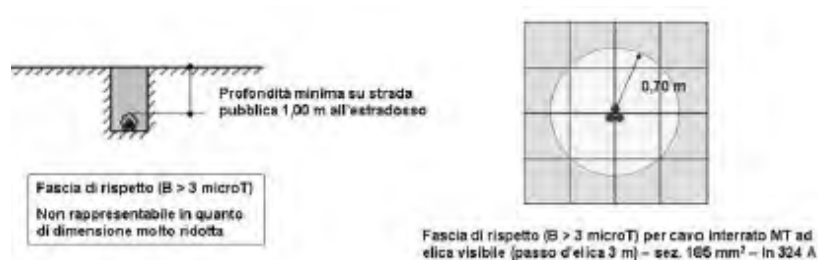
Fascia di rispetto per un cavo MT 3 \times 1 \times 185 \text{ mm}^2 ad elica visibile
